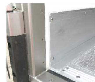
Goma rotura puente térmico y perfil de aluminio transición a piso
