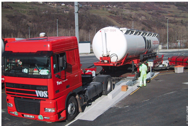
Imagen 18. Operación de carga de un semirremolque en un vagón Modalohr
