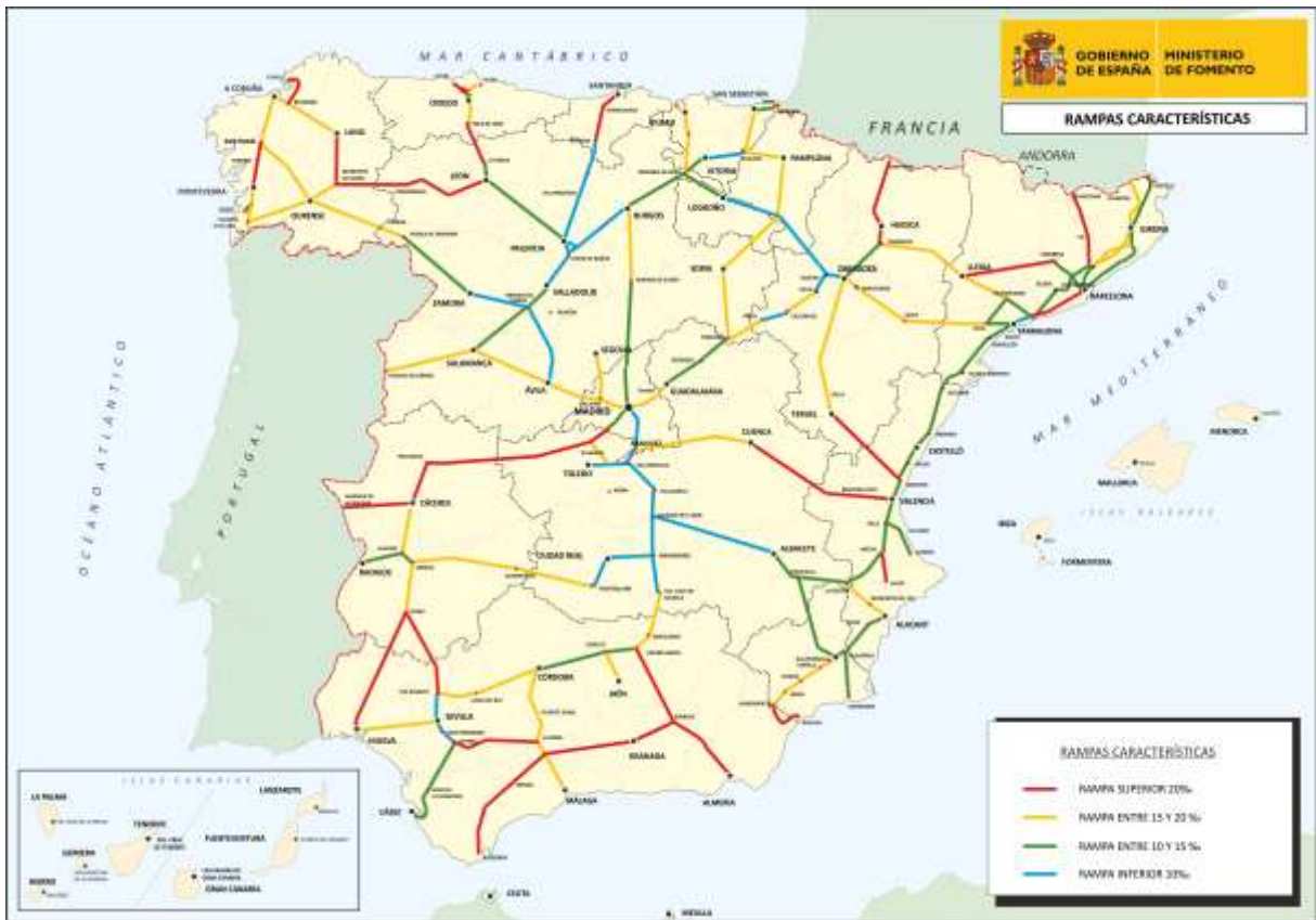
Figura 93. Rampas características de la red ferroviaria convencional
