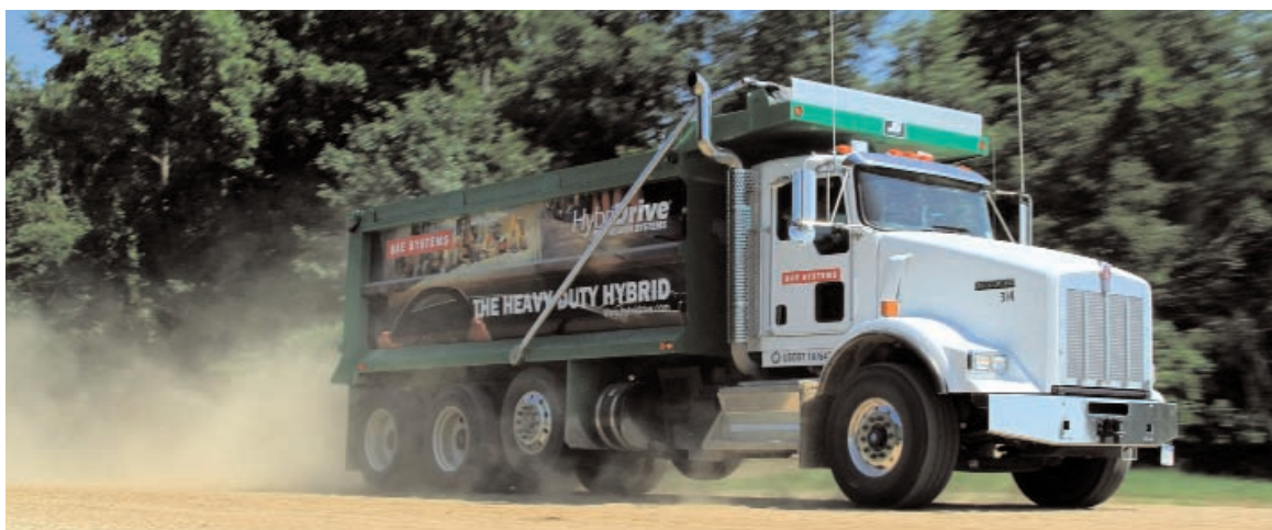
La compañía estadounidense BAE Systems asegura que su sistema Hybri-Drive, propulsión híbrida en paralelo, reduce el consumo de gasóleo del orden del 30 por ciento en los camiones pesados.
