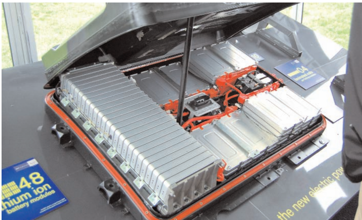
Los automovilistas tienen que olvidarse de la idea generalizada de que las baterías que usan los coches eléctricos son similares a las de los coches con motor de explosión. La foto muestra el paquete de baterías del Nissan Leaf.
