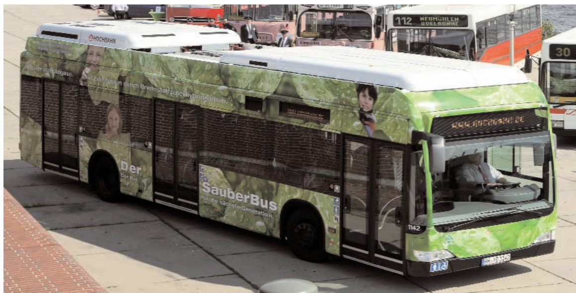
Daimler Buses ya dispone de vehículos para transporte colectivo de viajeros movidos mediante propulsión híbrida diésel-eléctrica en que la electricidad es generada a partir de una pila de combustible.
