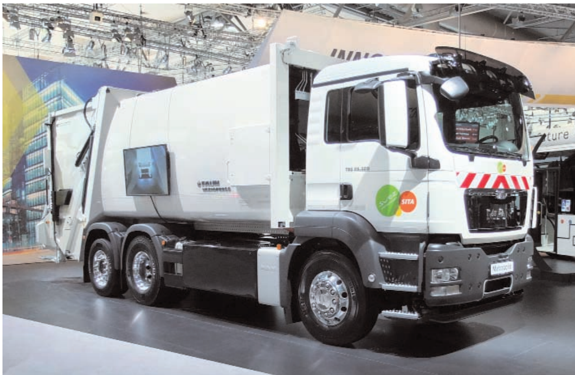
En la edición 2012 del Salón de Vehículos Industriales de Hanóver, MAN presentaba el modelo Metrópolis, un híbrido diésel-eléctrico que va a experimentarse en la recogida de residuos en el área de Amberes.
