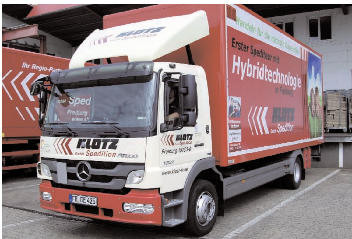
Los Mercedes-Benz Atego BlueTec Hybrid ya están siendo probados por algunos transportistas y Daimler Trucks cree que pueden conseguirse con ellos ahorros de hasta el 12 por ciento en el coste de combustible.
