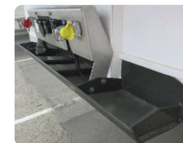
Soporte de conexiones inox y tope delantero de protección XLarge reforzado
